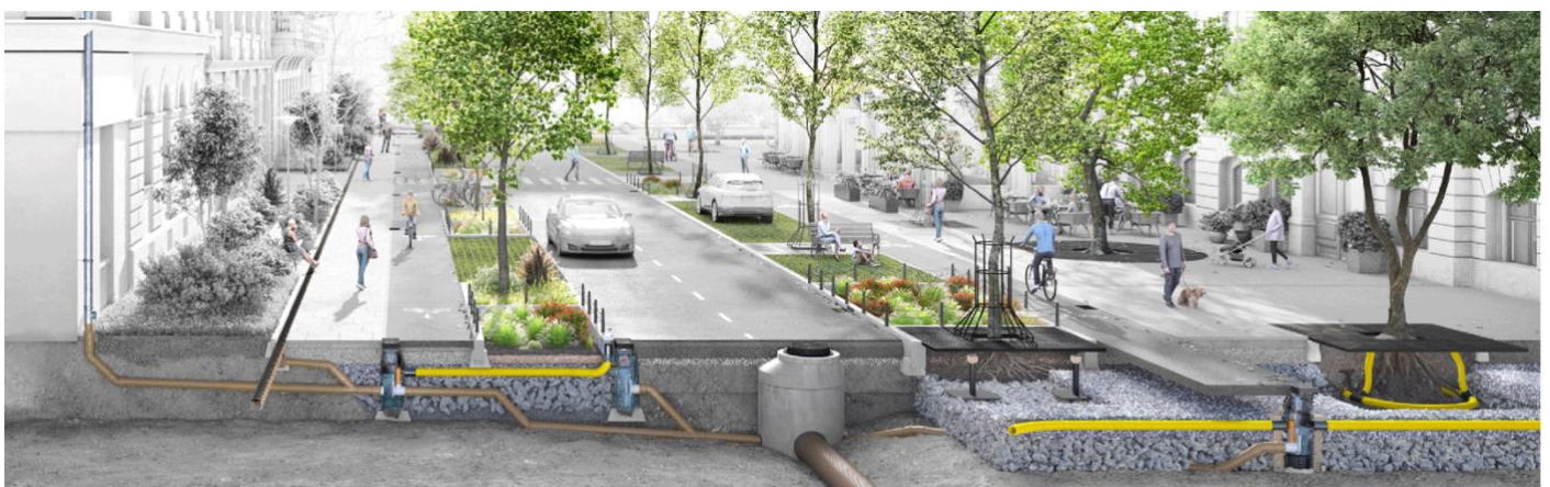
Mögliches Schwammstadtprinzip, Foto: Firma ACO AG Schweiz
